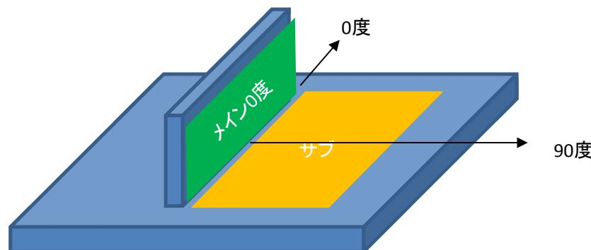
②FMSP800Wアンテナを平面上に設置時のアイソレーション 結果
